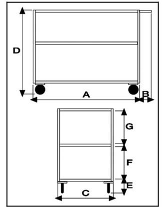
4 ruote girevoli, di cui 2 con freno in gomma antitraccia Ø 125
